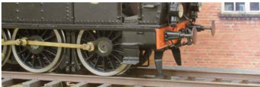
Flexräls från Micro Engineering med små diskreta spikar. Jag har här flyttat sliprarna så att slipersavståndet motsvarar måtten i SJ Banlära.
